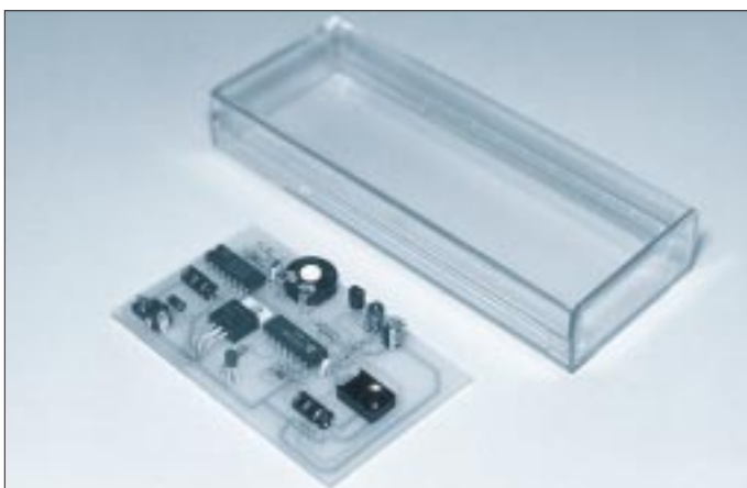
Bild 4: Das Gehäuse kann auf die Platinenmaße gekürzt werden.
