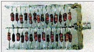
Das Geheimnis der Konstruktion liegt in einer induktionsarmen Anordnung der parallel geschalteten Widerstände und einer forcierten Kühlung.
