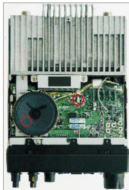
Bild 2: Das Innenleben des DX-70, wenn die obere Gehäusehälfte abgenommen ist. Im roten Kreis der Umschalter für die KW-Ausgangsleistung (100/50 W); der gestrichelte markiert die Lage des Mikrofon-Stellers, der sich unter dem Lautsprecher befindet
