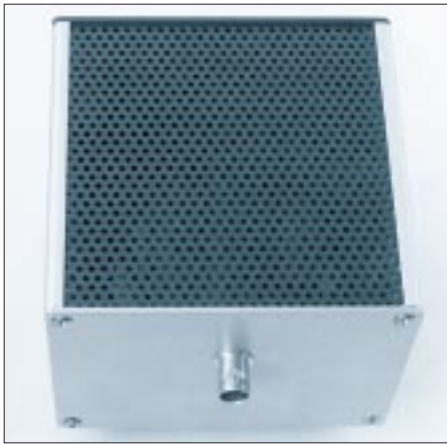
Bild 8: Der fertige Abschlußwiderstand. Der Deckel ist perforiert, damit die vom Lüfter geförderte Luft ausströmen kann.
